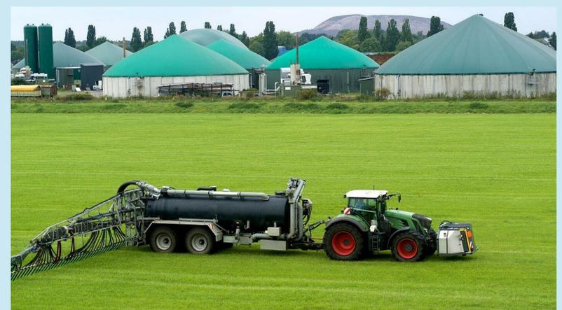
Abbildung 3: In den Versuchen erfolgt die Ausbringung mit Hilfe des SyreN-System der Firma Vogelsang. Die Technik lässt sich zumeist individuell an bereits vorhandene Ausbringtechnik nachrüsten. (Quelle: Vogelsang)
