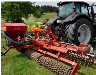
Nachsaatkombinationen mit Striegel, pneumatischem Sägerät und Prismenwalze eignen sich für Übersaaten als Pflegemaßnahme.
