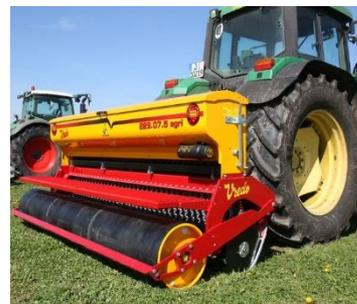
Durchsämaschinen bringen das Saatgut in den Boden ein und sind als Reparaturmaßnahme für lückige Bestände geeignet.
