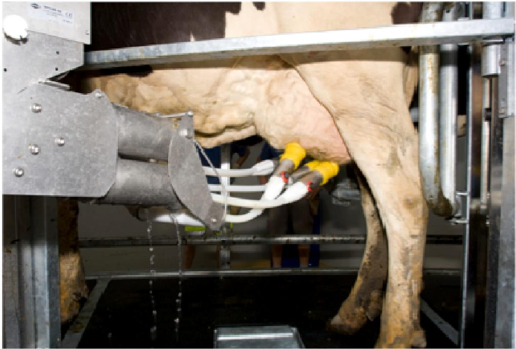
Abb. 19: Automatische Abnahme der Melkbecher nach dem Melken mit MultiLactor
