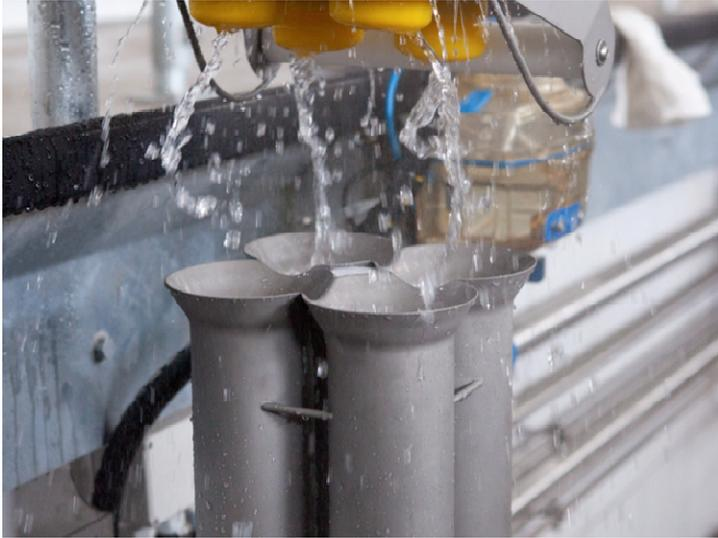
Abb. 20: Reinigen und Desinfizieren der Melkbecher nach dem Melken mit MultiLactor jeder Kuh von aussen und innen vollständig.
