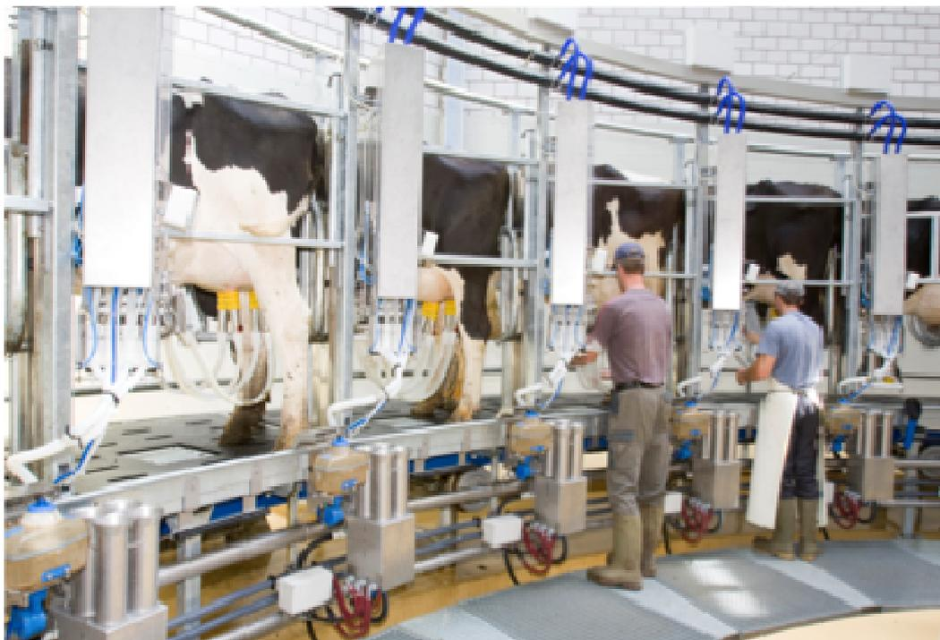
Abb.15: Das MultiLactor-Melksystem beim Melkprozess in einem Betrieb in der Schweiz mit 24 Melkplätze
