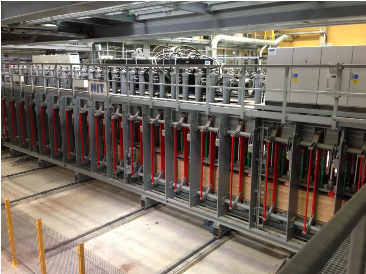
Abbildung 11: BauBuche GL70 in der Balkenpresse
