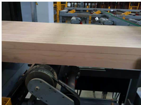
Abbildung 14: Auftrennen der BauBuche-Träger zur BauBuche Paneel
