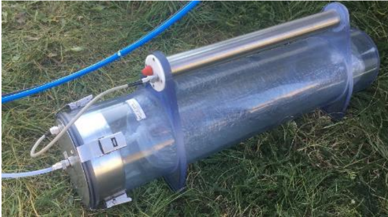
Geruchsprobenehmer CSD 30 der Firma Olfasense mit 10-Liter Probenahmebeutel aus Nalophan
