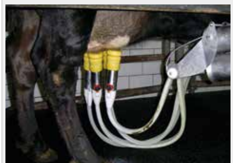
Aufliegende Schläuche verhindern die Übertragung der Impulse des Aktuators auf das Euter
