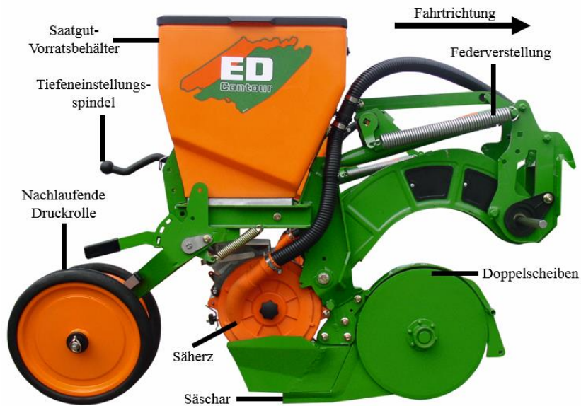
Einzelkornsäaggregat ED Contour (verändert nach AMAZONE, 2013)
