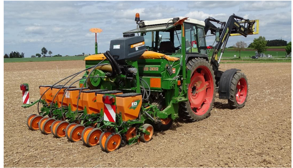
Aussaat der Silphie mittels Einzelkornsaat
