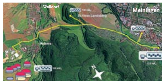
Abb. 6 Biogasanlage Rippershausen mit Satelliten-BHKWs nach Meiningen (Quelle: Ingenieurbüro Dr. Markert, Karte Google Earth)
