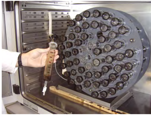
Abbildung 2: Rotoraufbau im Trockenschrank bei dem Versuchsaufbau der TLL
