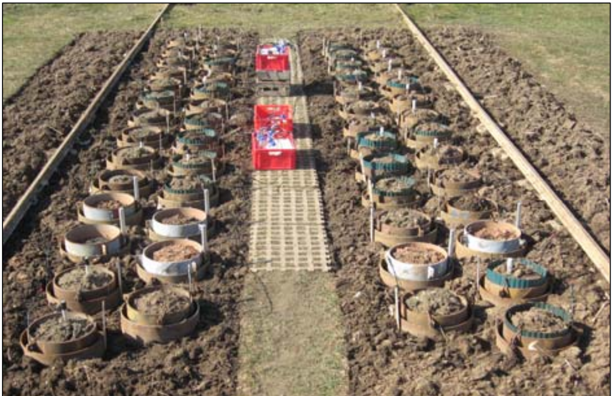
Abbildung 3: Anordnung der Behälter im Modellversuch mit Kleinlysimetern mit Sickerwasserentnahme
