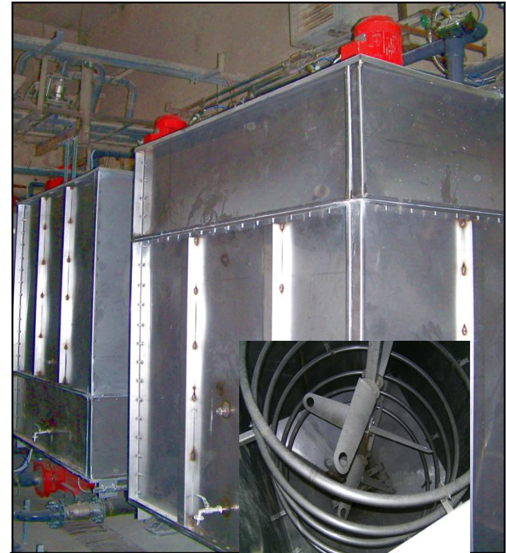
Fermenter für TLL-Fütterungsversuche mit je 5,5 m 3 Volumen (Innovationsförderung TH)
